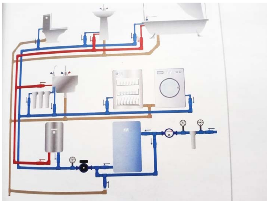
Водоводна и грејна инсталација у стану
