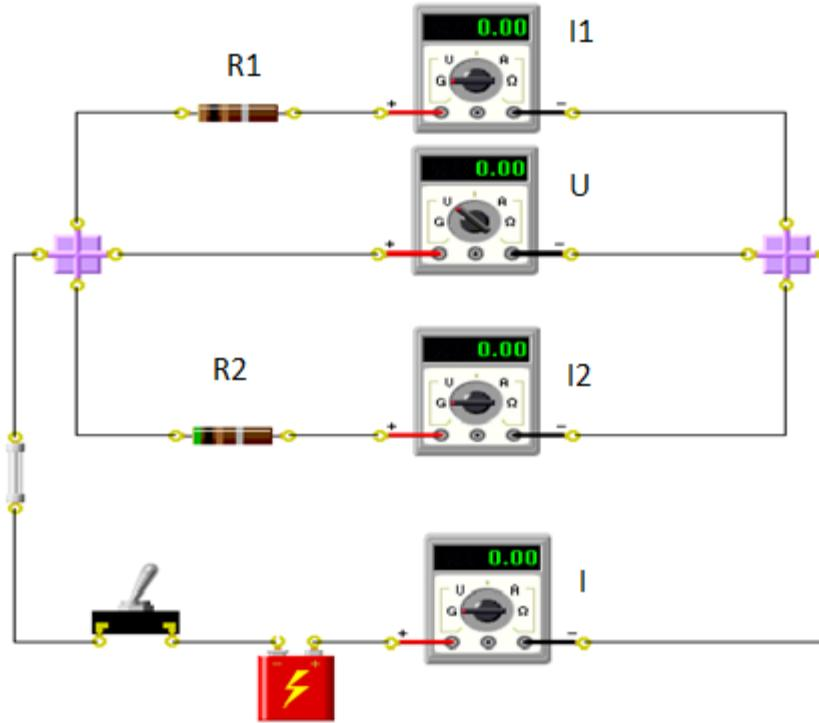
Pošto kolo bude formirano, iz *Construct* moda preći u *Run* mod i zabeležiti sledeće izmerene vrednosti za I1 – Struju kroz prvi otpornik; I2- struju kroz drugi otpornik, U – Napon na paralelnoj vezi otpornika (instrument u sredini), I -struju u kolu (pre ili posle paralelne veze otpornika), menjajući redom vrednosti para otpornosti R1 (gornji) i R2 (donji), kao u tabeli:
