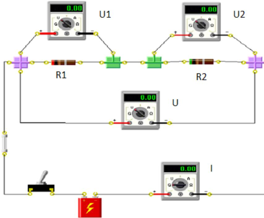
Pošto kolo bude formirano, iz *Construct* moda preći u *Run* mod i zabeležiti sledeće izmerene vrednosti za: U1 – napon na prvom otporniku ; U2- napon na drugom otporniku, U – Napon na oba otpornika, I -struju u kolu, menjajući redom vrednosti para otpornosti R1 (prvi) i R2 (drugi), kao u tabeli:
