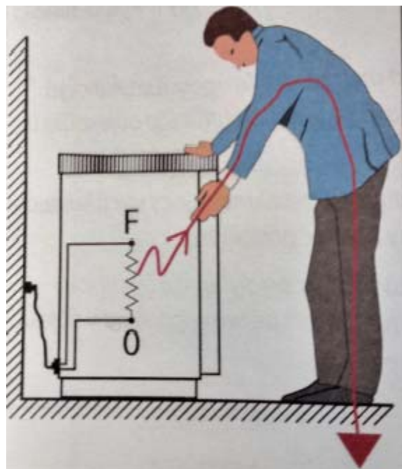
струјни удар изазван неисправним уређајем; путања струје кроз тело
